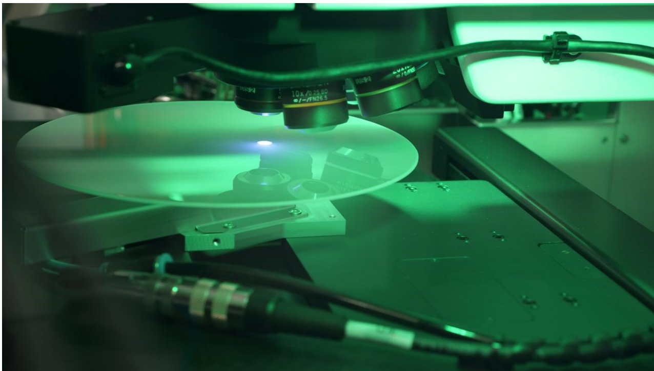
Obrázek 1. Safírový wafer pod mikroskopem řady MX. S laskavým svolením spol. PVA SPA.
